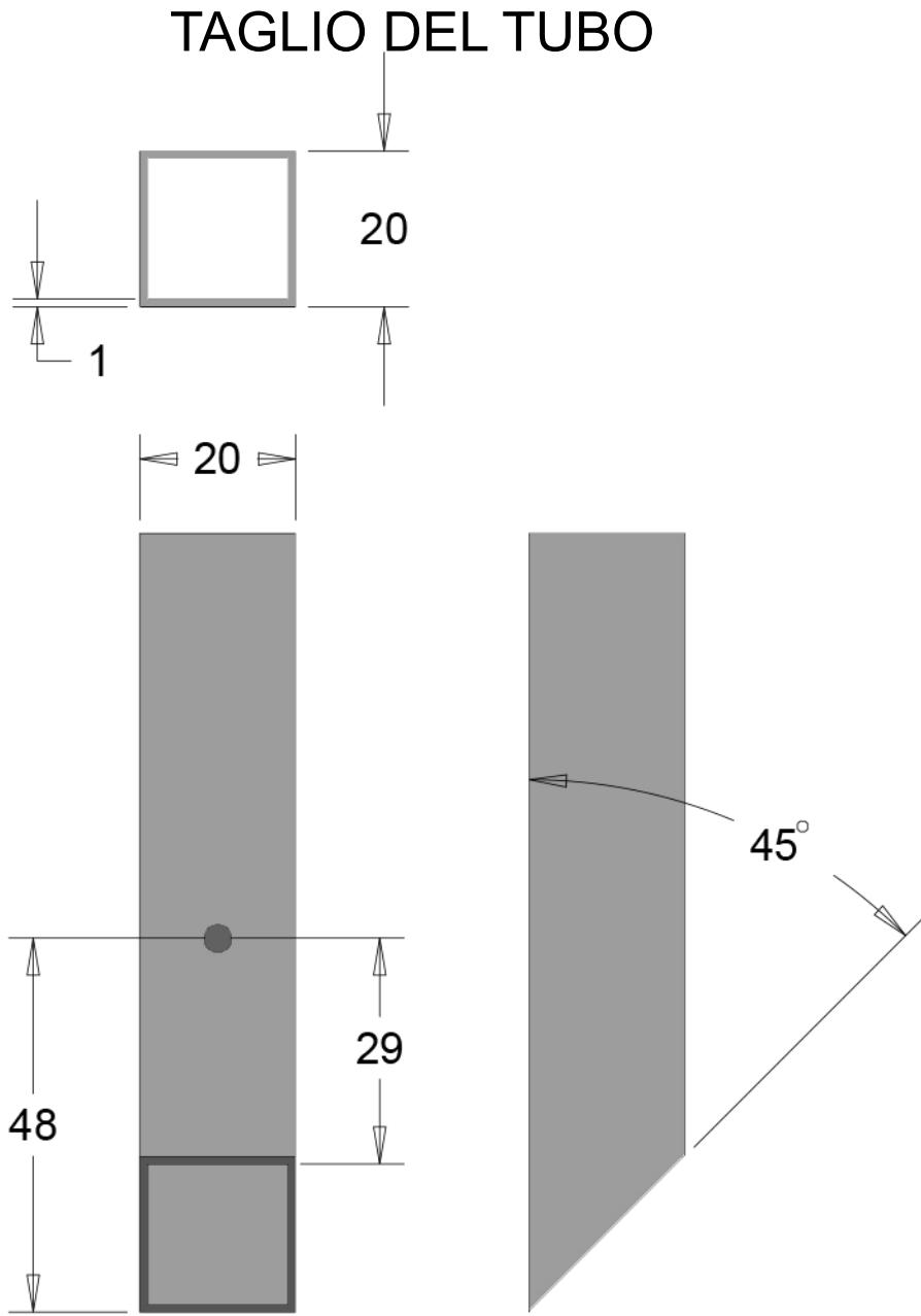
GIUNTO A 1 VIA A SCOMParsA A 45° INTERNO CON BASE 20X20X1 MM -
